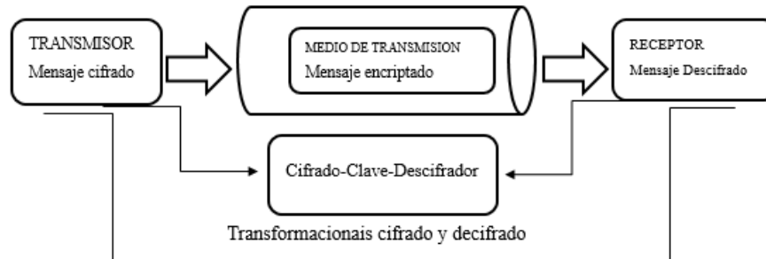
Fig. 1. La figura muestra el proceso de transmisión de los datos en una comunicación simple entre el transmisor y receptor.
