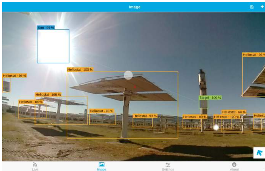
Figura 4: Captura de pantalla del sistema de control con Tensorflow sobre el campo CESA
