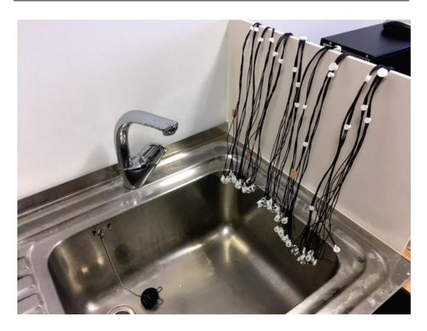
**NOTA**: Los electrodos se pueden mojar y lavar, pero es IMPORTANTE EVITAR A TODA COSTA que el amplificador o los cajetines de conexión del juego de electrodos se mojen, ya que el sistema podría quedar totalmente inservible.
