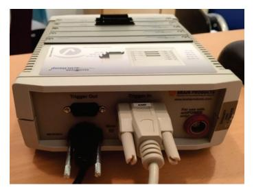
5. Conectar el amplificador del sistema de 64 electrodos (módulo superior) a la batería (módulo inferior) a través del cable adaptado que aparece a continuación.
