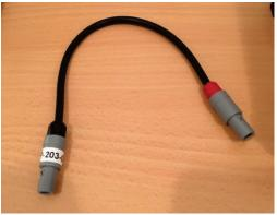
La parte roja del cable se conecta en el amplificador y la parte negra a la batería.
