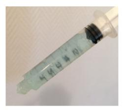
Cuando se haya rellenado la jeringa, hay que inserta la cánula con la que vamos a inyectar gel en los electrodos. Para ello unimos la cánula a la punta de jeringa y la enroscamos hasta el final para asegurarnos que al inyectar el gel no expulsemos la cánula.
