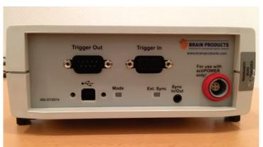
El cable gris se conecta en el puerto *Trigger In* y el cable negro al puerto con el símbolo de USB (\*\*). En ambos hay que apretar los tornillos laterales para fijar bien la conexión.
