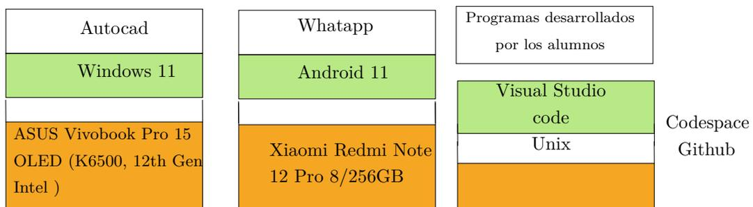
En esta imagen se destacan no los dispositivos físicos, puesto que los programas se almacenan en en la memoria (primaria y/o secundaria), sino que destacamos los distintos tipos de software que se pueden encontrar, y que se organizan por niveles.
