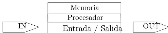
La memoria almacena datos y programas. Los dispositivos de Entrada/Salida permiten intercambiar información con el exterior. El procesador es el elemento de control que realiza las operaciones elementales del tratamiento de la información interna y de las operaciones de entrada/salida de la información al exterior (de acuerdo con los programas almacenados en la memoria). Es usual llamar **periféricos** a los dispositivos electrónicos que conforman las unidades de entrada y de salida.
