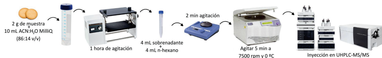
Figura 2. Método analítico seguido para la determinación de micotoxinas en galletas.
