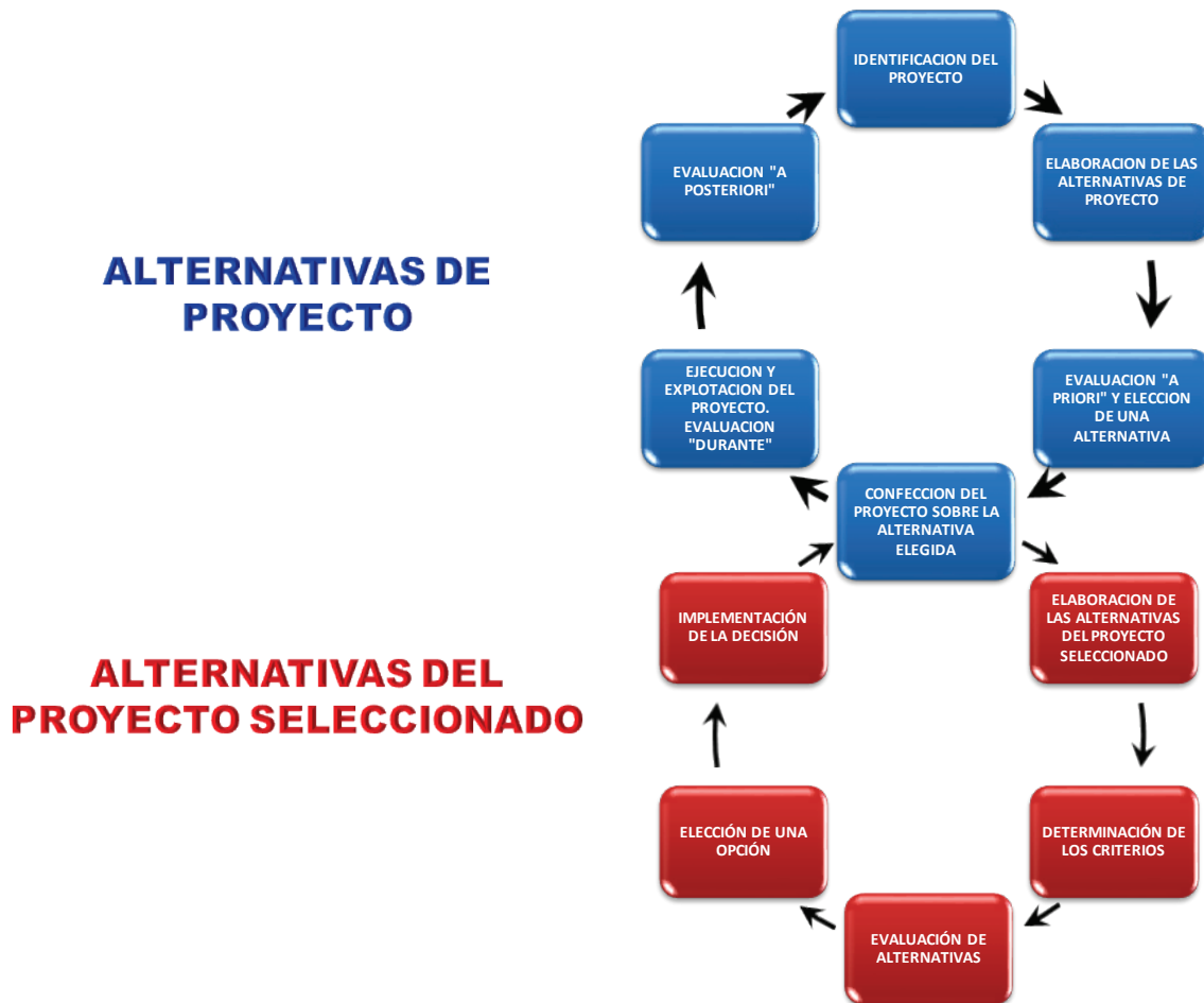
Figura 2. Procedimiento cíclico para evaluar y elegir entre diversas alternativas de proyectos y de alternativas del proyecto seleccionado.
