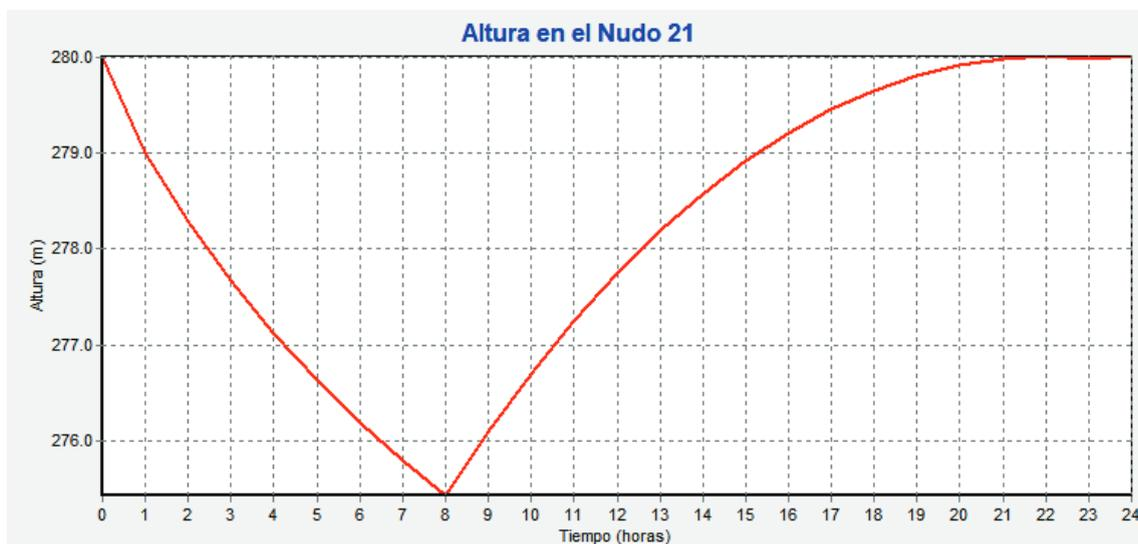
Figura 38. Perfil de altura del agua para el pozo representado por el depósito 21
