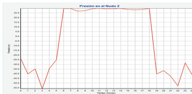
Figura 43. Perfil de presiones para el nudo 2
