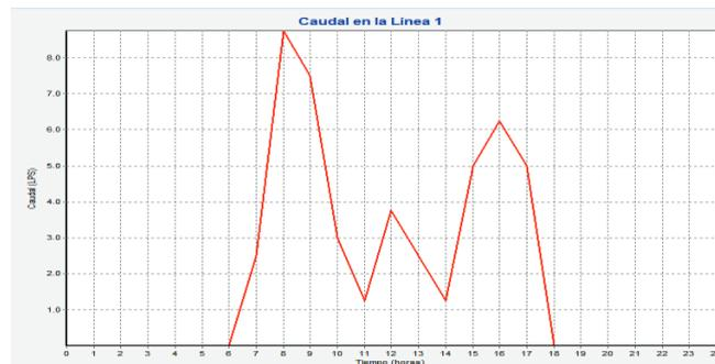
Figura 45. Evolución del caudal en una tubería
