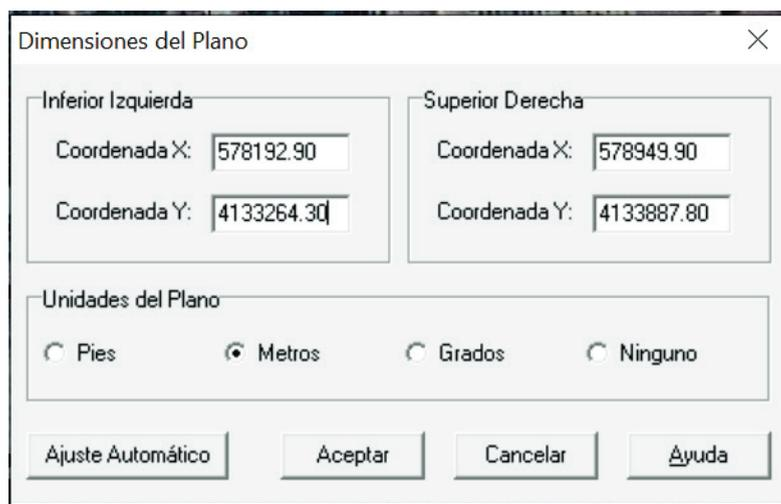
Figura 7. Georreferenciar la imagen en EPANET
