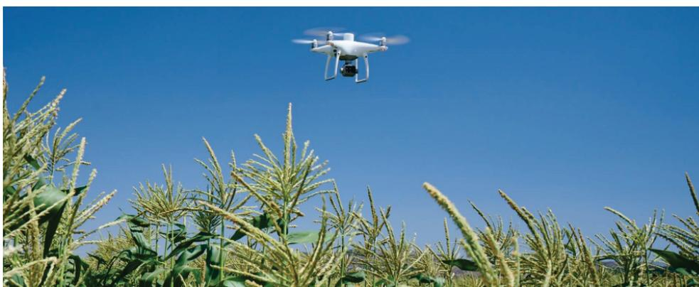
**Figura 2. Dron DJI PH4 Multiespectral** (<https://ag.dji.com/es/p4-multispectral>)
